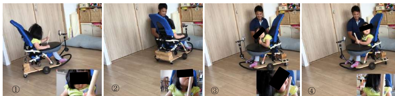
図8：①前進する，②壁にぶつかると棒を顎に当て後進する，③偶然方向転換する，④方向転換したことに気づき前進する
